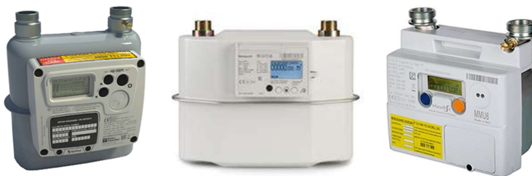
7.3. ábra: Pietro Fiorentini ultrahangos gázórája (bal) [54], Honeywell EI5 membrános okos gázórája (középen) [55], valamint a MeterSIT's Domusnext 2.0 MMU6 H 2 gázórája (jobb) [56]
