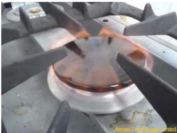
4.2. ábra: A Hy4Heat projekt keretében fejlesztettek olyan speciális égőrozsákat, amelyek a hidrogén közel szintelen lángját szabad szemmel látható sárgás színre festik
